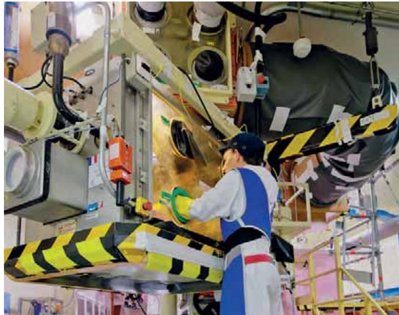
CADARACHE // FRANCE Démantèlement d'une boîte à gants.
