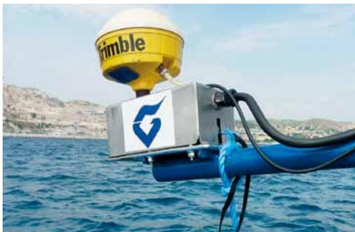
**Développé par GEOCEAN** (ENTREPOSE Contracting), ce système de largage automatique de bouées facilite le repérage de précision des mines lors des opérations de déminage portuaire.
