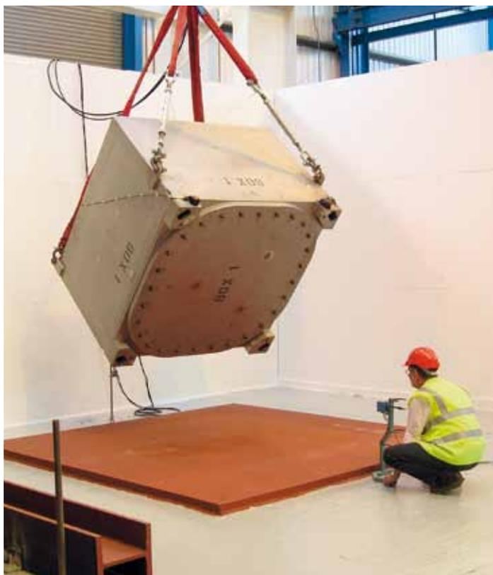
**Test de résistance au choc au Technology Centre** de VINCI Construction UK, où sont réalisés toutes sortes d'essais, depuis l'étanchéité des façades rideaux jusqu'à l'identification des pathologies du bâtiment.
