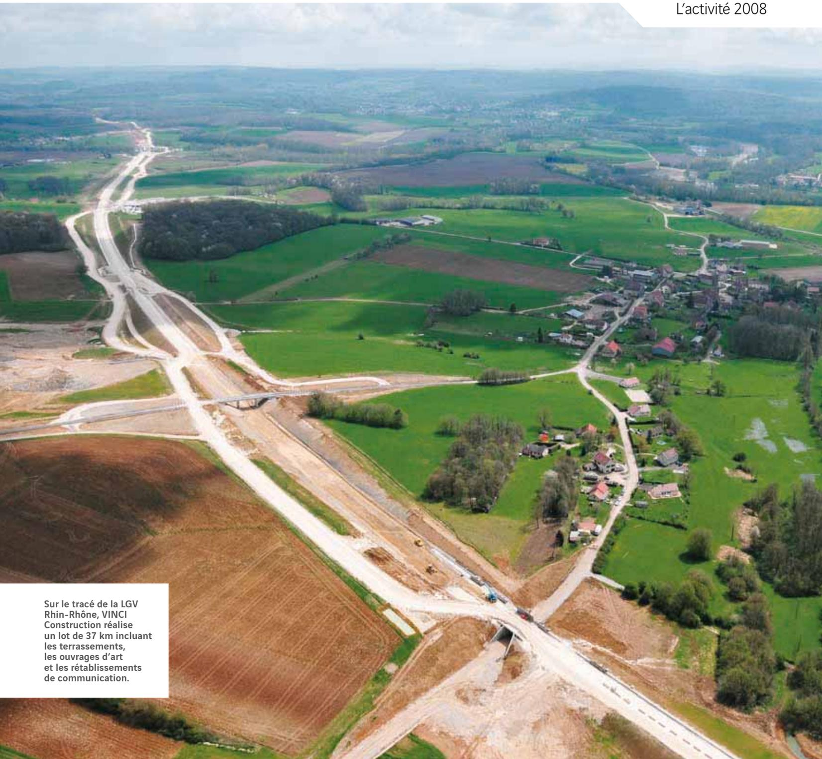
Sur le tracé de la LGV Rhin-Rhône, VINCI Construction réalise un lot de 37 km incluant les terrassements, les ouvrages d'art et les rétablissements de communication.
