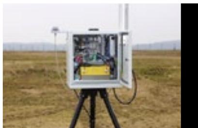
Envinet a également joué un rôle clé dans un grand nombre de projets R&D à l'échelle nationale et internationale. Le développement du système de sondes gamma intelligentes NuEM EGM en est une belle illustration. Les sondes gamma intelligentes sont notamment utilisées pour les contrôles environnementaux extérieurs (contamination radioactive et pollution,
