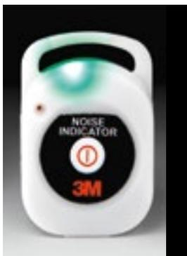
Afin de réduire les temps d'exposition au bruit, le département Mechanical Protection de Nuvia Protection a équipé l'ensemble de son personnel d'appareils indicateurs de bruit. Cet équipement, pré-réglé au seuil de 85 dB, clignote « vert » lorsque l'on se trouve dans une zone non dangereuse pour l'ouïe et bascule au « rouge » lorsque l'ambiance nécessite le port obligatoire d'une protection auditive. Il permet ainsi d'assurer le port de protections auditives individuelles lorsque nécessaire.
