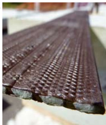
□ Aplicación de las armaduras EcoStrap® en la planta de DLB.
