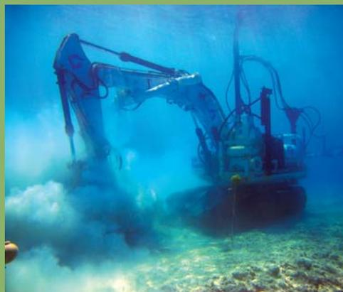
Excavatrice sous-marine télé-opérée Abyss, développée par Geocean et utilisée en 2016 sur le projet Escondida Water Supply au Chili.
