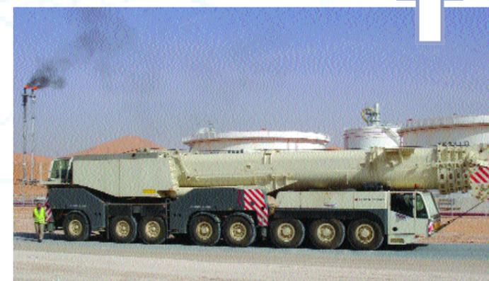
Pour réinjecter le gaz à 407 bars dans le réservoir souterrain, les ingénieurs de conception ont prévu l'utilisation d'un turbocompresseur d'une puissance de 28 mégawatts ISO. Afin d'installer cet équipement (arrivé en trois éléments principaux d'environ 100 tonnes) on a dû mobiliser une grue autoportée d'une capacité exceptionnelle (500 tonnes) sur le site de MLN, situé en plein désert du Sahara à plus de 1.000 km de la capitale.
