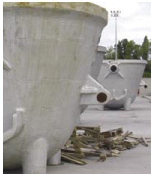
L'imposante masse de chacune des nombreuses poches à scories de l'aciérie Carinox à Charleroi.
