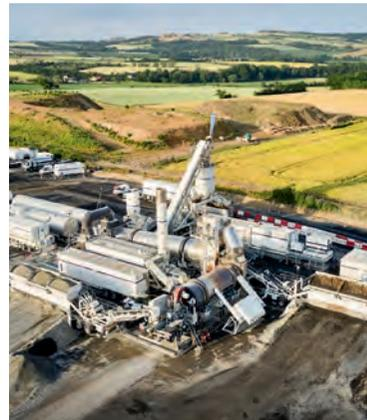
Usine mobile de production d'enrobés recyclés d'Eurovia, alimentée avec un biocombustible, implantée à proximité d'un chantier de rénovation des chaussées sur l'A89.
