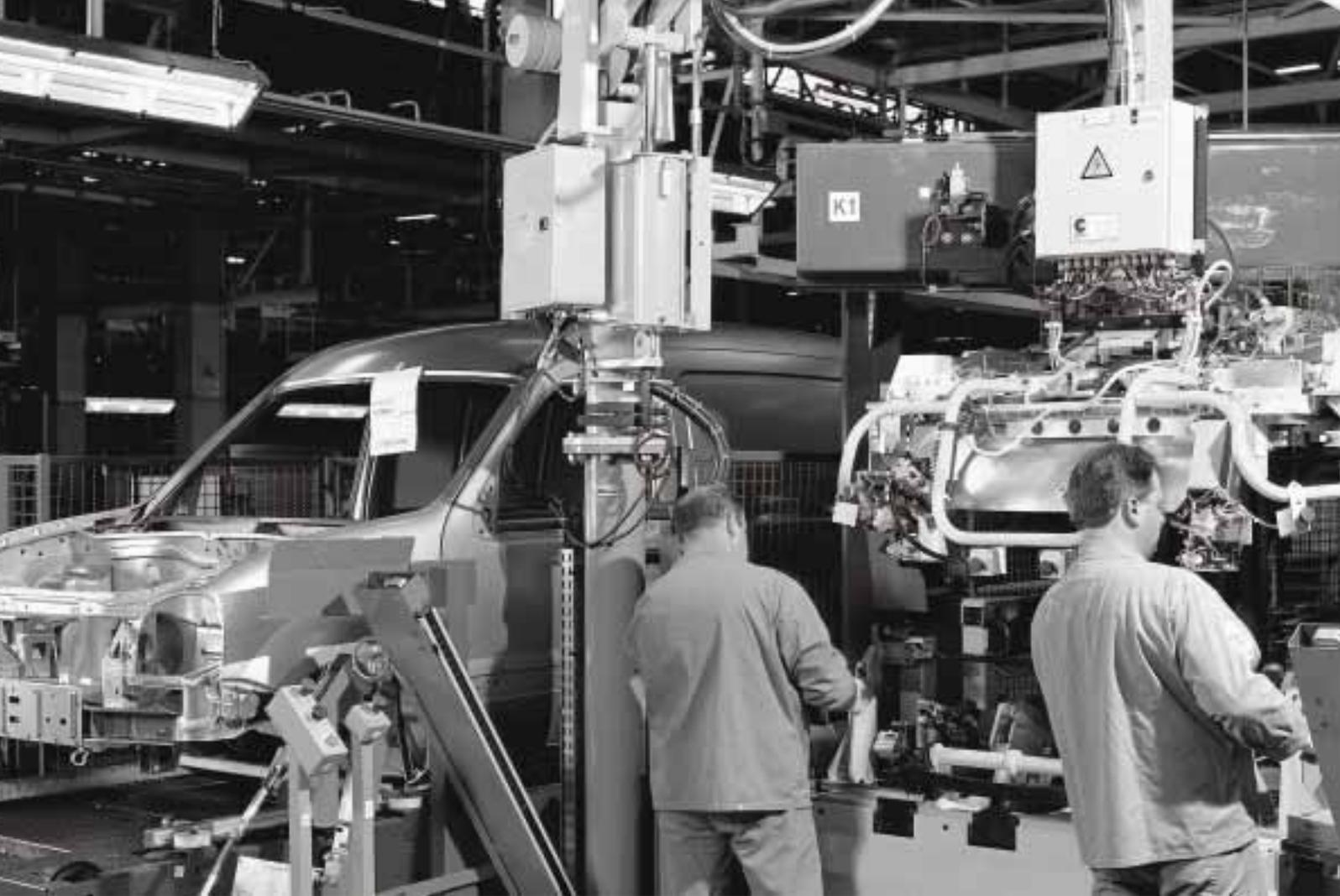
*Automatisierung der Karosseriespengerei im Renault-Werk Maubeuge, in dem der Kangoo gebaut wird.*
