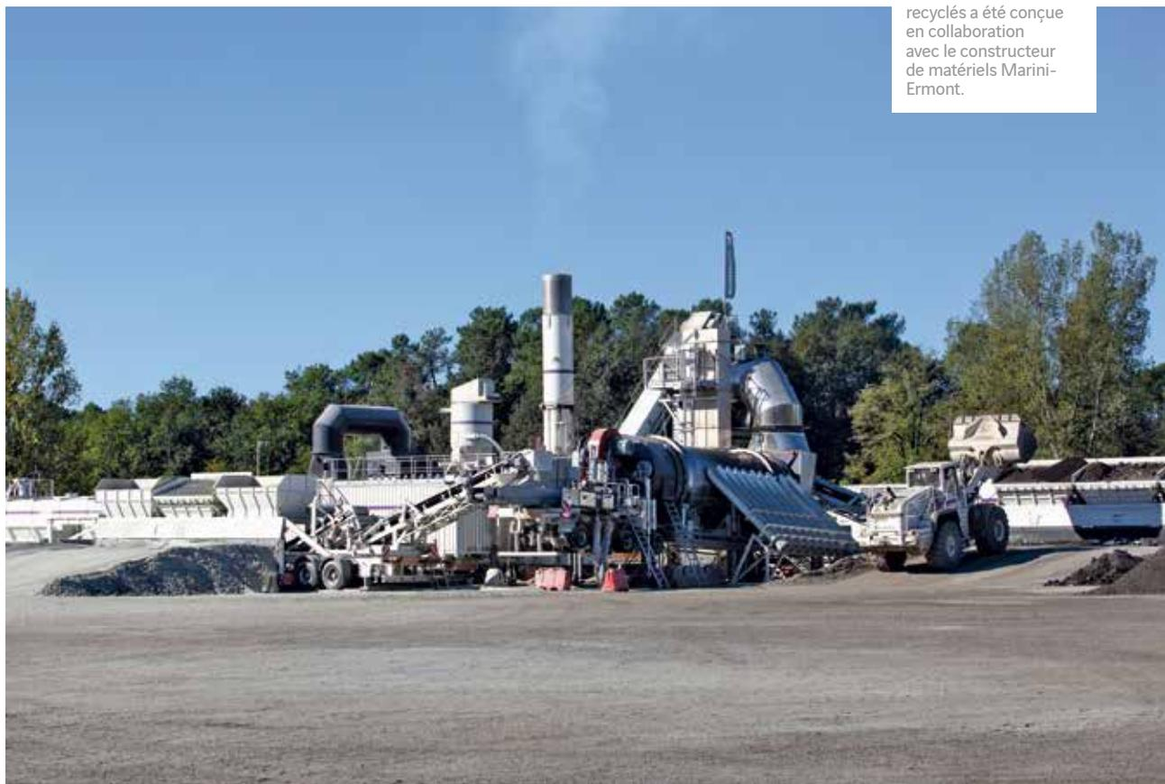
— **La filiale de VINCI** spécialisée dans la construction d'infrastructures de transport et d'aménagements urbains signe une avancée majeure dans l'économie circulaire : la première usine mobile au monde capable de fabriquer des enrobés routiers contenant jusqu'à 100 % de matériaux recyclés.
