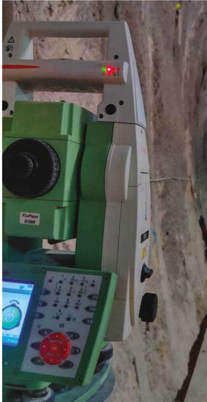
**DISCO est un outil pour guider les mineurs lors de l'excavation de tunnels en conventionnel.**
