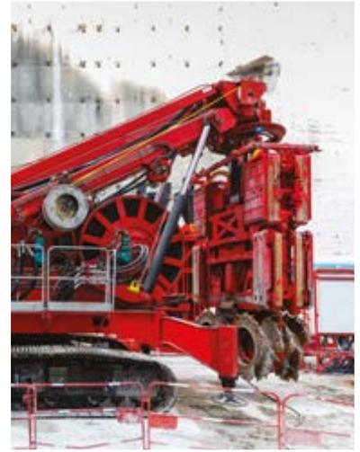
↑ **Dans le cadre du lot Est du projet Thames Tideway Tunnel,** une Hydrofraise® électrique est mobilisée pour réaliser les parois des puits de plusieurs sites. Cette Hydrofraise® est plus respectueuse de l'environnement et beaucoup plus silencieuse – le moteur électrique remplace le moteur diesel –, minimisant ainsi les nuisances pour les riverains du chantier.
